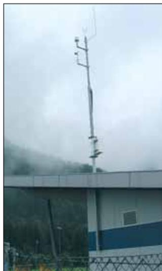
Ultraschallwindmessung, Registrierung der Globalstrahlung und Sonnenscheindauer
